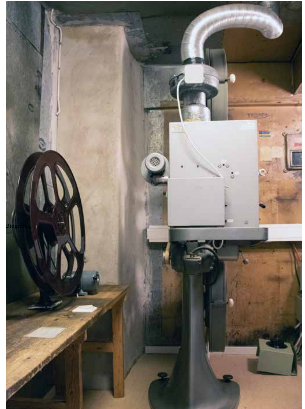
Maskinrummet. Vänster : Projektorn är ett hopbygge av moduler från flera olika tillverkare. Här syns projektorverket av modell AGA Ultra. Höger : Maskinrummet med det stående spolbordet till vänster. Genom alla år har Röda Kvarn endast haft en projektor, vilket föranlett paus mitt i filmen för omladdning och bensträckning.
